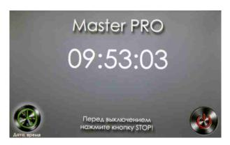
Управление прессом заблокировано кнопкой Стоп, под дисплеем управления. Поверните кнопку по часовой стрелке и слегка потяните на себя, управление будет разблокировано и на дисплее появится кнопка включения систем пресса «Пуск». По нажатию данной кнопки произойдет полное включение всех управляемых систем пресса, пресс будет готов к работе. На дисплее отобразится страница «Основное меню».
