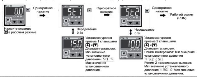
• Режим установки автоматической чувствительности (F-2)
