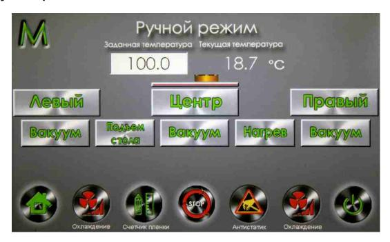
Ручной режим предназначен для управления циклом прессования в ручном режиме. В верхней части дисплея расположено активное окошко заданной температуры, по нажатию на окошко всплывает цифровая клавиатура, после задания температуры (max. 180 градусов Цельсия), необходимо нажать клавишу ввод и температура запишется в активном окошке как заданная.
