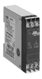
Предназначено для контроля трехфазных сетей на неправильную последовательность фаз. При надлежащей последовательности фаз выходное реле остается притянутым, желтый индикатор горит. При ненадлежащей последовательности фаз или при фазовом рассогласовании выходное реле возвращается в состояние покоя и желтый индикатор гаснет. У двигателей, продолжающих работу на двух фазах, СМ-РFE распознает обрыв фазы, если обратное напряжение не превышает 60% от изначально приложенного напряжения.
